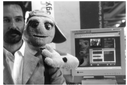
Bild 1 Der Telebuddy, ein physischer Avatar für Internet-Teilnehmer einer realen Veranstaltung, mit seinem Träger. Im Hintergrund sieht man die Bildschirm-Darstellung mit Live-Videobild und Chat-Kommunikationsfeldern für die Gesprächspartner im Internet.
