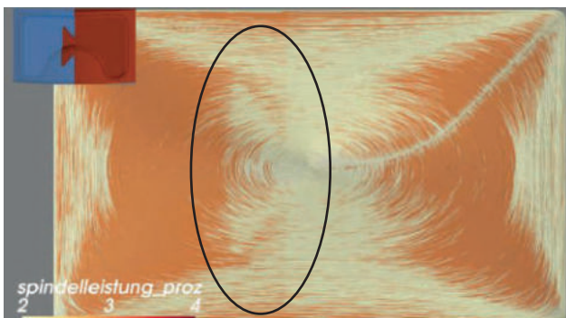
Abb. 5 (links): Härteunterschied im Material, hier erkennbar über eine Kombination aus Spindelleistung und Achsdaten; Abb. 6 (rechts): Bohrungen im Material, hier auf Basis eines Körperschallsensors
